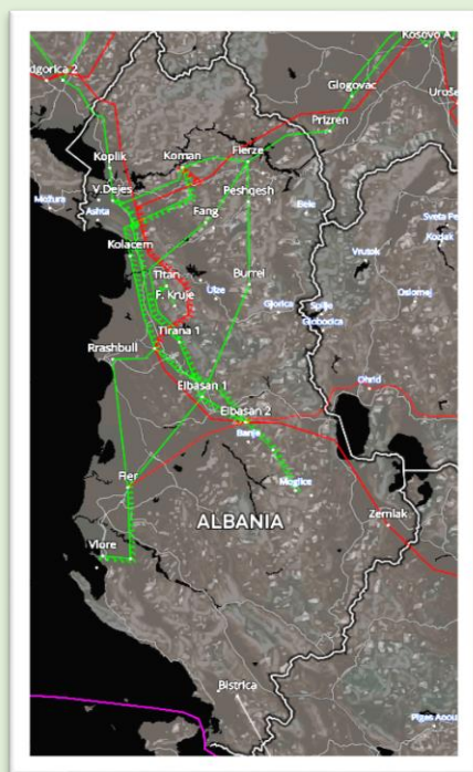
Figura Nr.41. – Harta e Shqipërisë me linjat e shpërndarjes së energjisë elektrike (të tensionit të lartë 220 & 330 kV).
