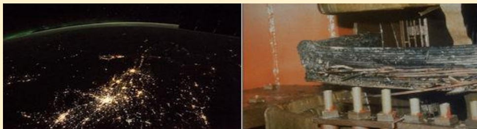
Figure Nr.5 - Një ndërprerje e energjisë (majtas) dhe dëmtim i transformatorit (djathtas) gjatë stuhisë së marsit 1989. / A power blackout (left) and transformer damage (right) during the March 1989 storm.
